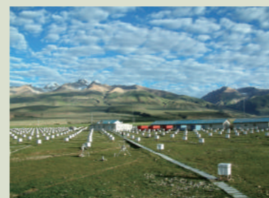
地表の空気シャワー検出器で初めてガンマ線観測に成功したチベット空気シャワー観測装置。宇宙線研究所と中国が共同で開発し、1989年、標高4,300メートルにあるチベット自治区ヤンパーチンに建設。空気シャワー最大発達の高高度を利用して最先端の観測を繰り返しています。
