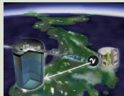
長基線ニュートリノ振動実験 T2K(Tokai-to-Kamioka)は、茨城県東海村にある加速器でつくったニュートリノを地中295km飛ばしスーパーカミオカンデで捉え、ニュートリノの種類がどれくらいの割合で変化したかを調べる実験です。
