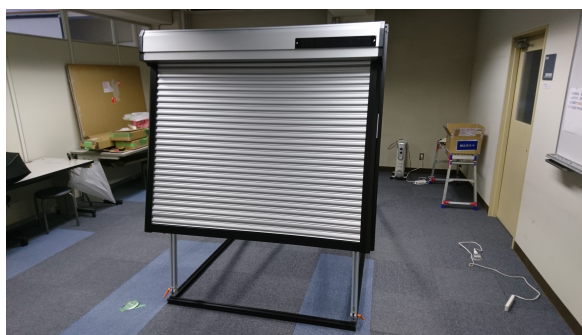
図1：シャッターを取り付けた CRAFTT 試験開発機
