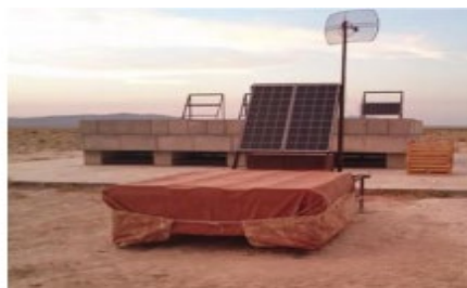
図1: 3 m 2 にくみ上げられた鉛サンドイッチ検出器とコンクリート遮蔽を持つ検出器
