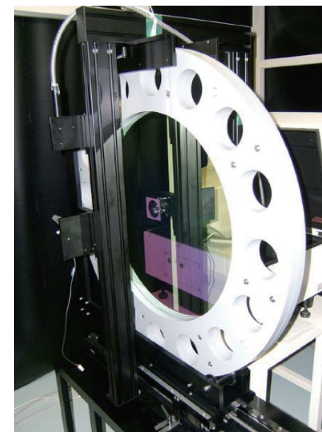
図3 開発中のすばるHSC用狭帯域フィルター(Materion[旧 Barr Associates社]と協力)。
