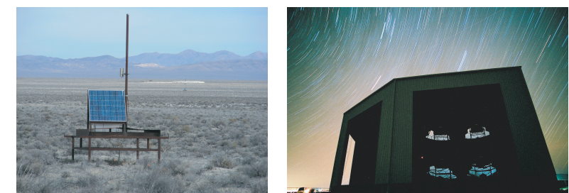
図2 (左図) 砂漠に基盤目状に設置したTAの地表検出器。後方に更に4台が見える。(右図)TA大気蛍光望遠鏡。光電子増倍管によるカメラを用いて空気シャワーからの紫外発光を高速・高感度で撮影する。
