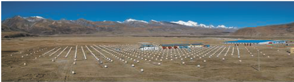
図1 チベット空気シャワー観測装置(標高4,300m、羊八井宇宙線観測所、チベット、中国) Fig.1 Tibet air shower array, located 4,300m above sea level, Yangbajing, Tibet, China.
