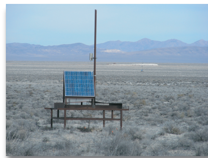
図2 砂漠に1.2km 間隔の碁盤目状に設置されたTAの地表検出器。後方に更に4台が見える。
