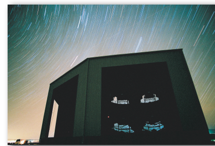
図3 観測運用中のTA大気蛍光望遠鏡。光電子増倍管によるカメラを持ち、空気シャワーからの紫外発光を高速・高感度で撮影する。
