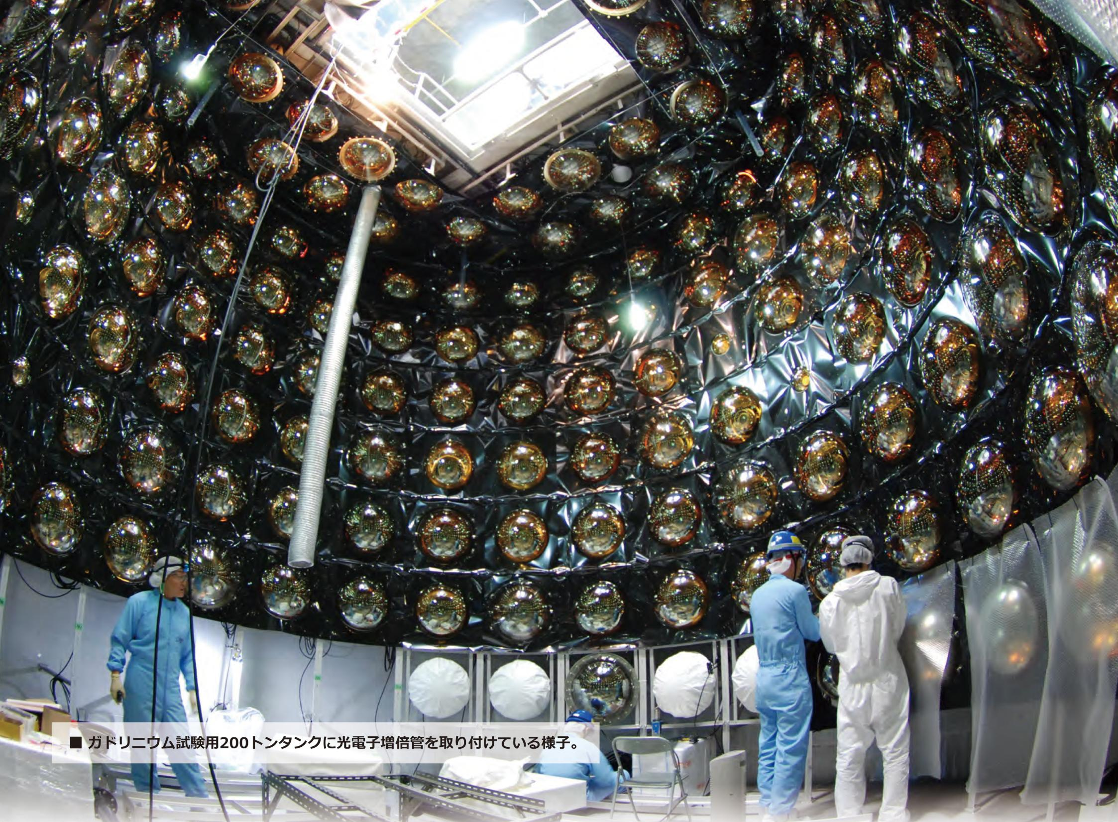
■ ガドリニウム試験用200トンタンクに光電子増倍管を取り付けている様子。
