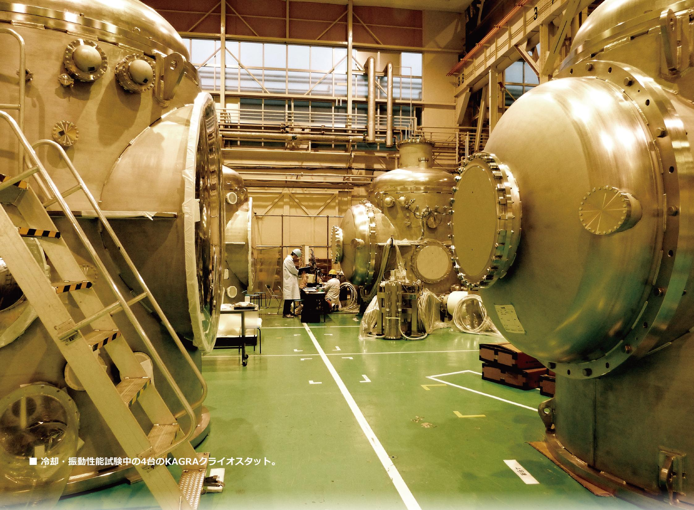
■ 冷却・振動性能試験中の4台のKAGRAクライオスタッフ。
