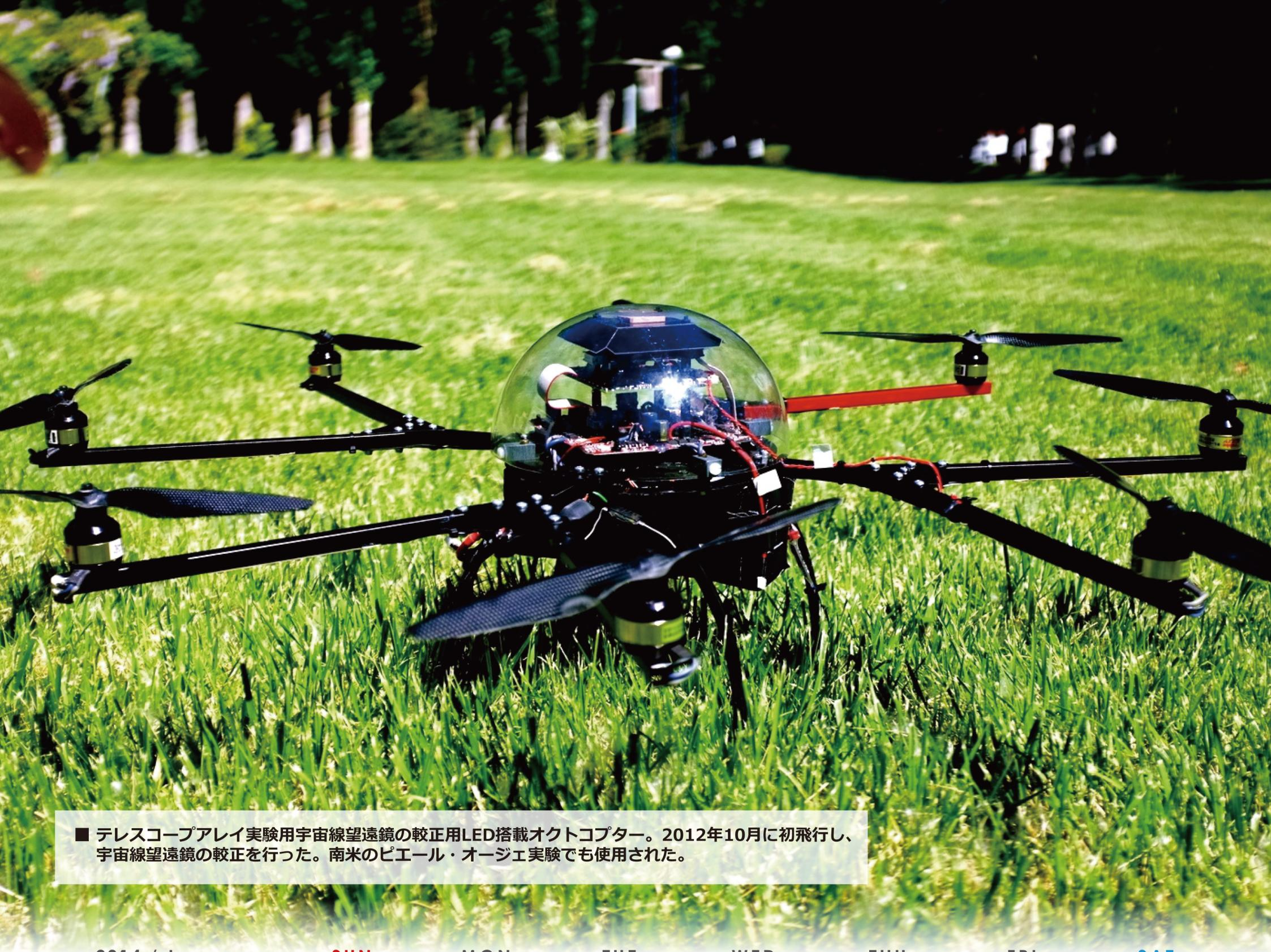
■ テレスコープアレイ実験用宇宙線望遠鏡の較正用LED搭載オクトコプター。2012年10月に初飛行し、宇宙線望遠鏡の較正を行った。南米のピエール・オージエ実験でも使用された。
