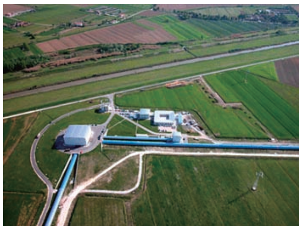
図5：European Gravitational Observatory (EGO) が運営するフランス・イタリア合同の Virgo 検出器。ピサ近郊にあり基線長 3 km で低周波領域まで効果のある防振装置 SAS に特徴がある。
