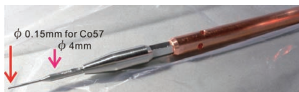
図8：エネルギー再構成に用いるロッド先端部 ( ^{57}\text{Co} の場合) ロッドによって、シンチレーション光が遮られない様、細棒の先に線源を取り付けている
