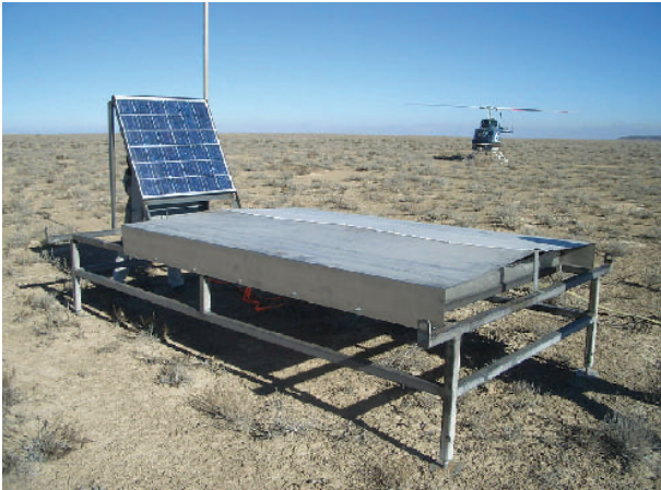
写真2：試験設置した地表検出器（2004年12月）。検出器は、アレイ内の十数か所に設けた中間集積点までトレーラで運び、そこから環境負荷の少ないヘリコプターを使って設置することが、連邦土地管理局（BLM）から要請されている。この他にも、無線LAN・GPS タイムスタンプ・ソーラーパネルなどの使用によって、環境に最大限の配慮をした自立型検出器としている。
