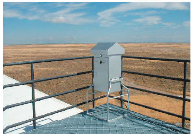
写真2：TA 宇宙線望遠鏡建家屋上のアンダーセン捕集器の設置風景
