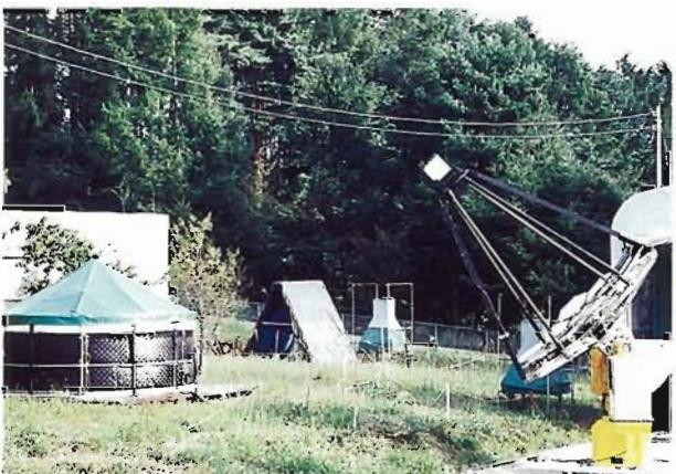
6. 図2の何もない坂に、現在は宇宙線望遠鏡プロトタイプ、シンチレーション検出器、連続観測用比例計数管、オージェ計画用水チェレンコフ検出器（右から）が並び、運動をする場所がない。
