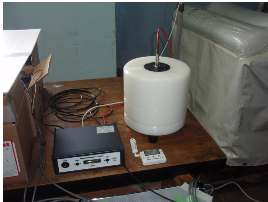
エネルギー拡張型レムカウンタ WENDI-II (0.025eV~5GeV) + データロガー・コントローラ NM10
