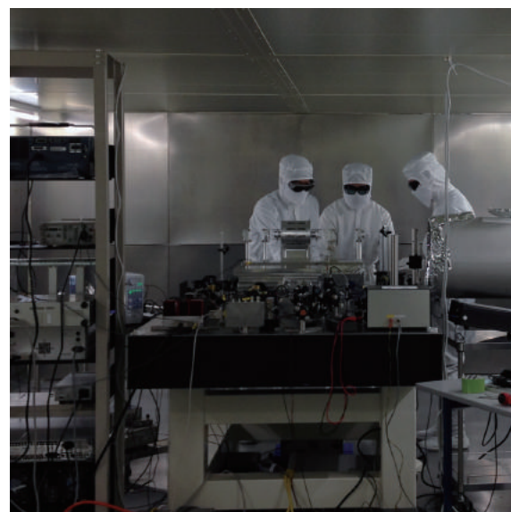
2 レーザーとレーザーを格納する ISO Class1 クリーンブース Laser system and ISO class 1 clean room for housing it
