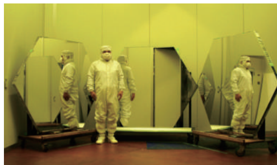
5 日本グループ、三光精衡所により試作された大口径望遠鏡用の高精度分割鏡。ミラーは 60mm 厚のアルミハニカムを 3mm のガラスではさんだサンドイッチ構造である。鏡表面は SiO 2 , HfO 2 の多層保護膜により長寿命、高反射率を実現する。Prototype of the high precision segmented mirror for the LST developed by CTA-Japan in cooperation with Sanko Co.LTD. The mirror is made of a 60mm thick aluminum honeycomb sandwiched by 3mm thin glass on both sides. A surface protection coat consisting of the materials SiO 2 and HfO 2 will be applied to enhance the reflectivity and to elongate the lifetime.
