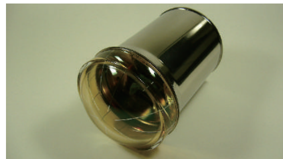
6 次世代 XMASS 検出器用に開発中の 3 インチ光電子増倍管 Newly developed 3-inch PMT for next generation XMASS detector
