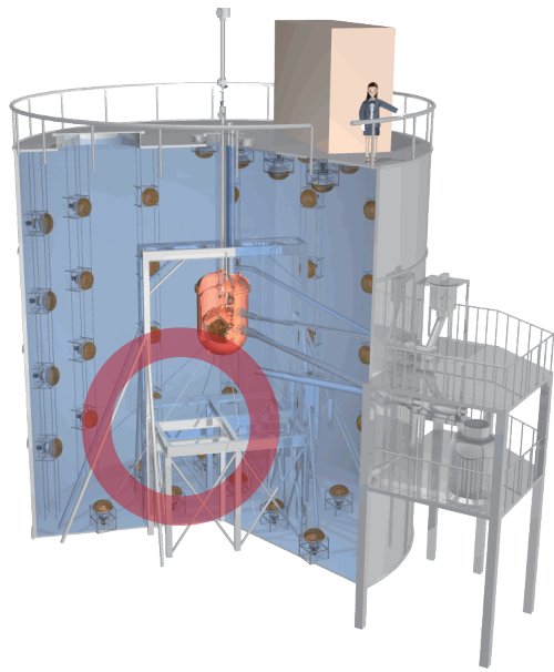
2 液体キセノン検出器 ⑥、と水放射線シールドの概念図 The schematic view of the detector and the water tank
