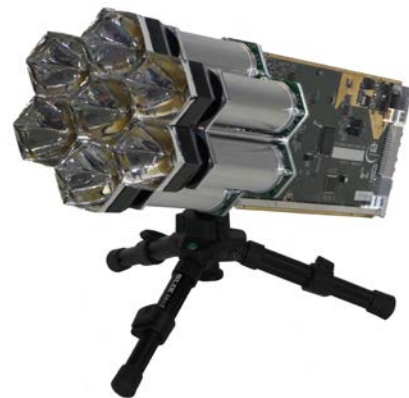
図 1、PMT モジュール。7 つの PMT に Light Guide を取り付け、それに読み出し回路を付けている。この PMT モジュールを単位にトリガー生成や電力供給が行われる。265 個の PMT モジュール、すなわち 1855 個の PMT により焦点面検出器が構成されている。
