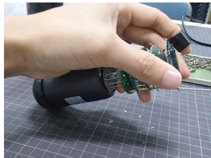
図 2、PMT ユニット製作。
