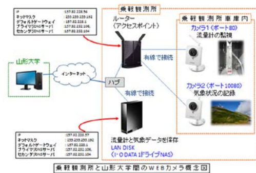
図1: リアルタイムモニター装置の概念図
