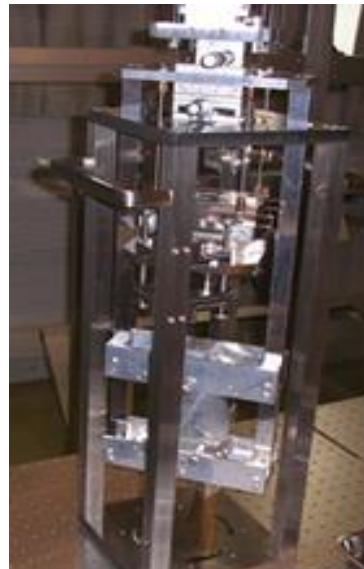
Fig.1 モードクリーナー用の防振装置
