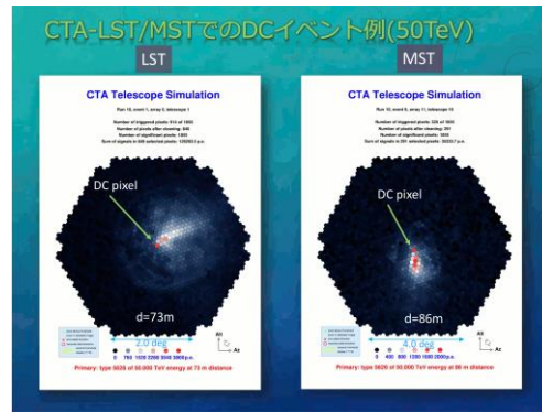
図 2: 鉄( z=26 )による Direct Cherenkov イベントの例(大石) [5]
