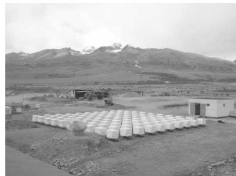
図1：Tibet III アレイの中心に設置した YAC-II (100 台のバースト検出器から成る)。
