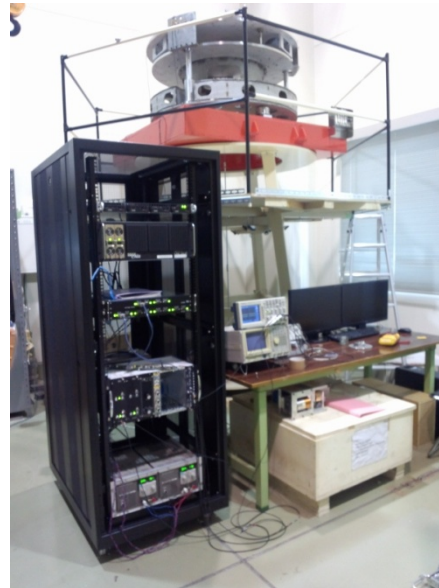
柏キャンパスにおけるPre-isolatorのプロトタイプ試験
