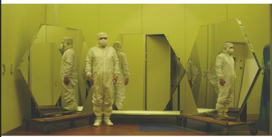
図1 CTA 大口径望遠鏡(23m) 用分割鏡の試作。鏡の構造は 3mm Glass + 60mm Al. Honeycomb + 3mm Glass からなる。コーティングは7層多層膜からなり、高い反射率、耐久性をもつ。
