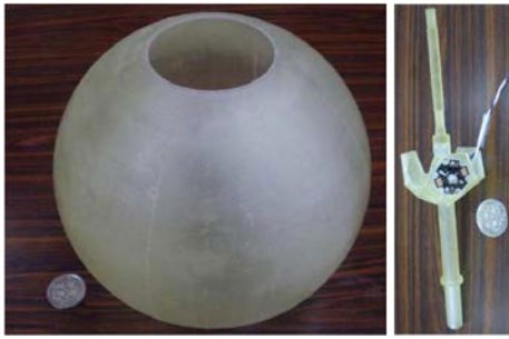
図 1. 光造形装置により成形された取付器具と，取り付けられた紫外 LED
