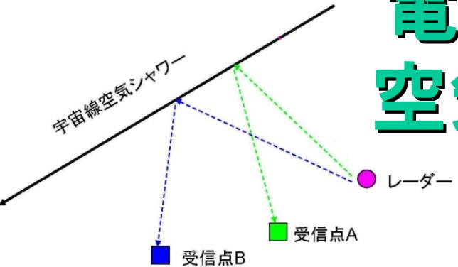
50MHz帯の電波を送信し、空気シャワー通過後に形成される電子柱における反射を受信
