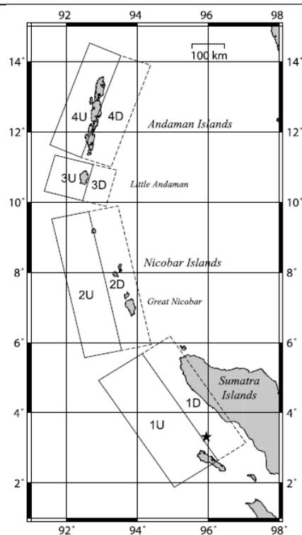
震源断層域を4領域に分割し、それぞれの領域の上下変動量、破壊の進行速度、破壊継続時間をパラメタとして変化させ、各地で計測された微気圧変動記録を最も良く説明するパラメタを推定した。その断層モデル(図2)は、震源の破壊がほぼ2.5km/sで南から北へ進行したことを示し、津波から推定される破壊伝播速度1.0km/sとは異なり、地震波観測から決定された破壊伝播速度と一致している。また、推定された上下動変動量はNicobar諸島で最も大きい。この結果は地震波から推定された地震モーメントの開放量がNicobar諸島付近で最大となっていることと合致している。微気圧計測データは、津波データから推定される震源破壊モデルよりも、地震波データから推定される震源破壊モデルを支持している。
