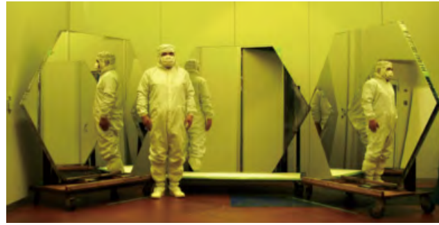
図5 日本グループ、三光精衛所により試作された大口径望遠鏡用の高精度分割鏡。ミラーは60mm厚のアルミハニカムを3mmのガラスではさんだサンドイッチ構造である。鏡表面はSiO 2 、HfO 2 の多層保護膜により長寿命、高反射率を実現する。 Prototype of the high precision segmented mirror for the LST developed by CTA-Japan in cooperation with Sanko Co.LTD. The mirror is made of a 60mm thick aluminum honeycomb sandwiched by 3mm thin glass on both sides. A surface protection coat consisting of the materials SiO 2 and HfO 2 will be applied to enhance the reflectivity and to elongate the lifetime.
