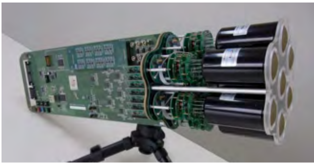
図4 日本グループが設計と製作を担当したクラスターモジュール。7本の高量子効率光電子増倍管、高圧回路、プリアンプ、スロー制御回路、超高速 DRS4 波形読み出し回路、トリガーからなる。256個を集めて大口径望遠鏡のカメラになる。 Camera cluster for the Large Size Telescope (LST) developed by CTA-Japan. This cluster consists of seven high quantum efficiency photomultipliers (R11920-100), CW High Voltages, pre-amplifier, Slow Control Board, DRS4 Ultra fast waveform recording system and Trigger. The LST camera can be assembled with 265 of these clusters, cooling plates and camera housing.
