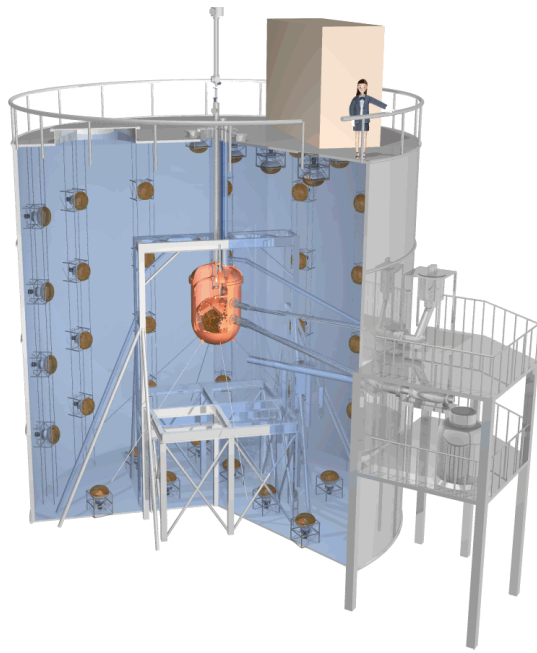
図2 水放射線シールドの概念図 (左) と液体キセノン検出器 (右)
