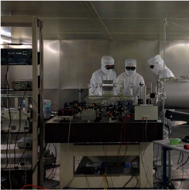
図2 レーザーとレーザーを格納する ISO Class1 クリーンブース Laser system and ISO class 1 clean room for housing it
