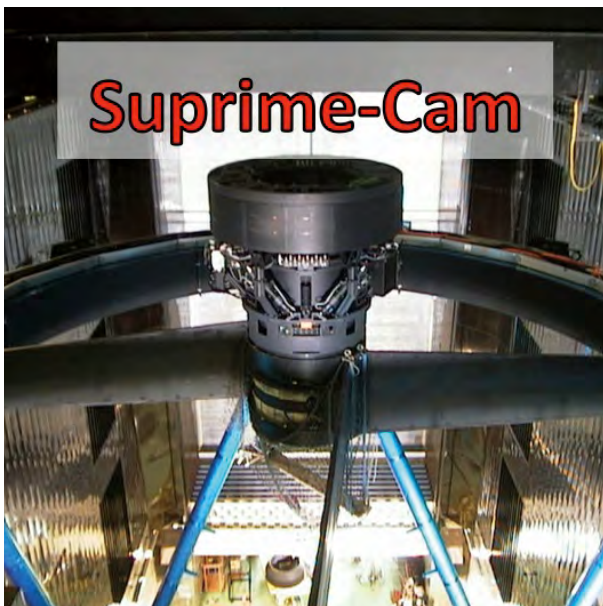
図4 すばる望遠鏡のトップリング上に装着された Suprime-Cam Suprime-Cam installed on the top ring of Subaru telescope
