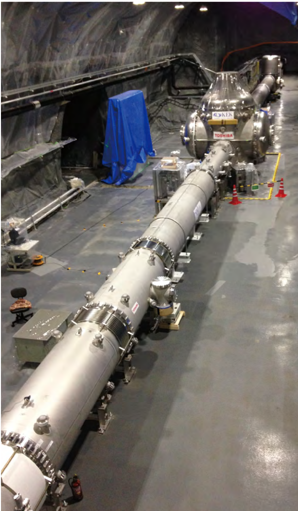
図3 中央実験室に設置されたクライオスタットと断熱真空ダクト Cryostat and radiation shield duct set in the corner station
