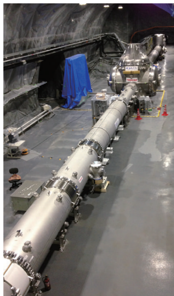
3 中央実験室に設置されたクライオスタットと断熱真空ダクト Cryostat and radiation shield duct set in the corner station
