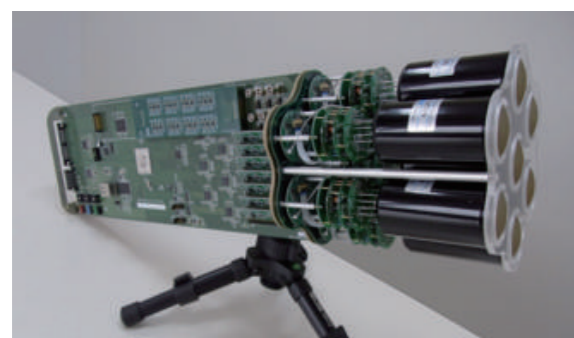
4 日本グループが設計と製作を担当したクラスターモジュール。7本の高量子効率光電子増倍管、高圧回路、プリアンプ、スロー制御回路、超高速 DRS4 波形読み出し回路、トリガーからなる。256個を集めて大口径望遠鏡のカメラになる。Camera cluster for the Large Size Telescope (LST) developed by CTA-Japan. This cluster consists of seven high quantum efficiency photomultipliers (R11920-100), CW High Voltages, pre-amplifier, Slow Control Board, DRS4 Ultra fast waveform recording system and Trigger. The LST camera can be assembled with 265 of these clusters, cooling plates and camera housing.
