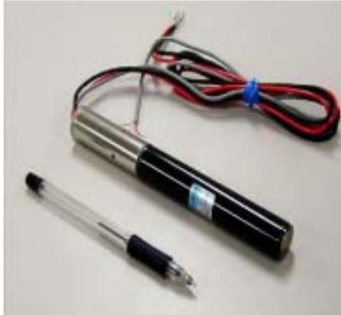
図 4.2: CANGAROO-III で用いられる PMT。内部にはディバイダー回路とアンプが内蔵されている。アンプの電源は、後述するフロントエンド回路からサポートされる。
