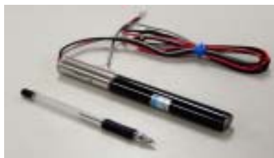
Figure 4.1: CANGAROO-III 望遠鏡のカメラに用いる PMT(Hamamatsu R3479)。直径 19mm の丸型で、有感領域の直径は 15mm 以上である。[Appendix A.1]
