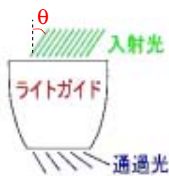
Figure 5.12: ライトガイドへの入射光と底面を通過する光の関係
