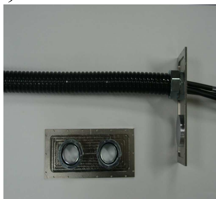
図 3.19: 3号機のカメラで使用しているパネルとケーブルエントリー 図 3.20: 4号機のカメラで使用しているパネルとケーブルエントリー
