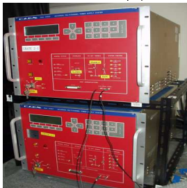
図 3.17: High Voltage Supply Unit 前面。PMT427チャンネル 図 3.18: High Voltage Supply Unit 後面。1クレートにつき 個々に独立に高電圧を印加できる 240ch 扱える。
