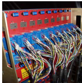
図 3.17: High Voltage Supply Unit 前面。PMT427チャンネル 図 3.18: High Voltage Supply Unit 後面。1クレートにつき 個々に独立に高電圧を印加できる 240ch 扱える。
