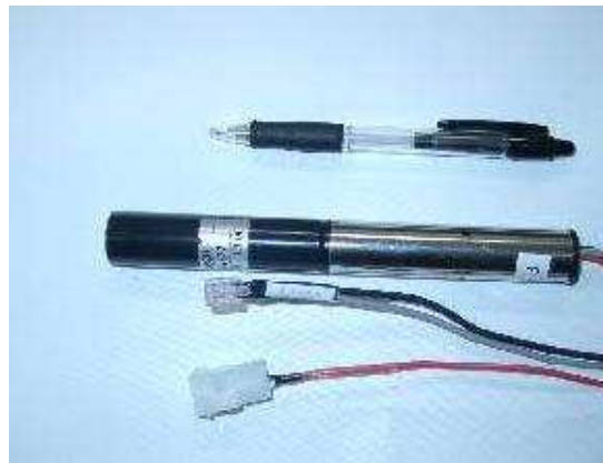
図 3.9: CANGAROO 望遠鏡で使用している光電子増倍管
