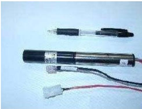
図 1.12: 光電子増倍管 (PMT)
