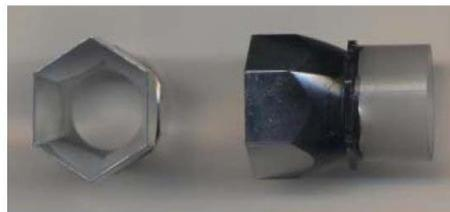
図 1.13: PMTの前面に付けられるライ
