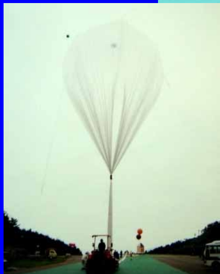
ロ - ラ車による 気球の立て上げ
