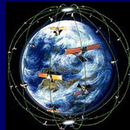
イリジウム : 66衛星 (6軌道面 × 11衛星)
