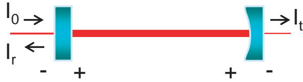
図 2.1: Fabry-Perot 共振器の概略図
